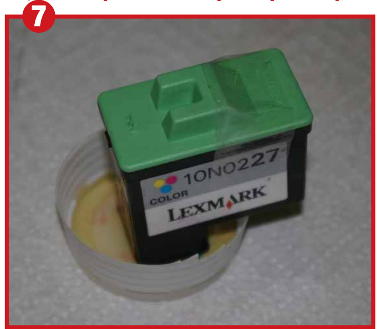
A questo punto la cartuccia va lasciata a riposo per qualche ora. In alcuni casi, si consiglia di metterla a bagno qualche minuto nell'apposito liquido di pulizia, per togliere dalla testina eventuali impurità
